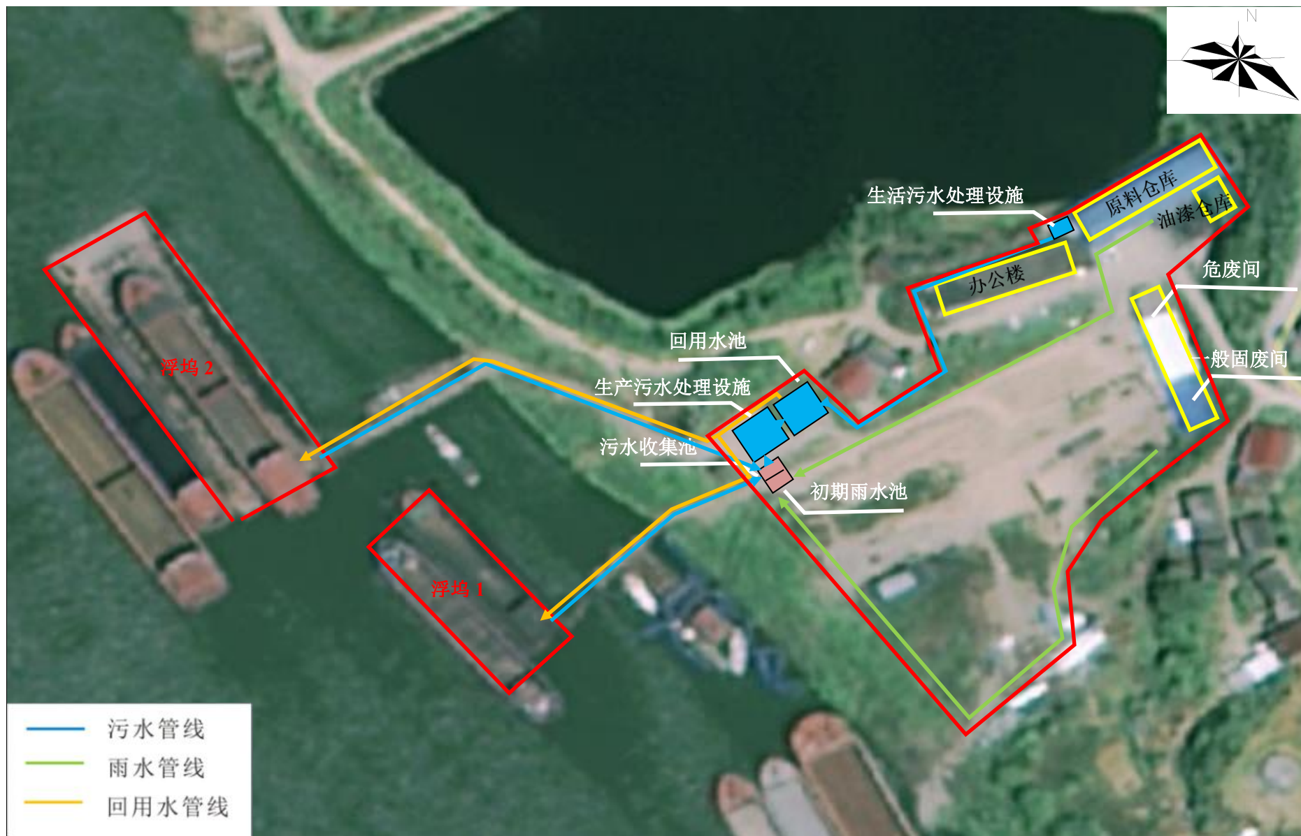
附图 5 项目雨污管网及回用水管网图
